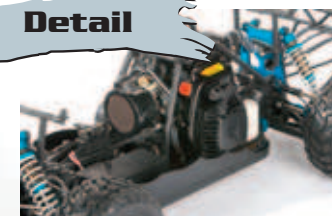
27 ccm 2-Taktmotor mit Ausschalter/27 ccm 2-stroke engine with off-switch
