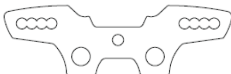
Firebolt oberer Querlenkerträger vorne, Kohlefaser A-01-VBC-6001 x 1
