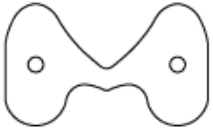
Firebolt DM Heckflügeleinstellplatte A-03-VBC-6037 x 2
